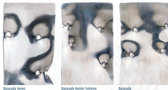
Beschuss von 1,6mm Aluminiumblech / Shots on 0.06 inch aluminum sheet / Βολές σε φύλλα αλουμινίου
